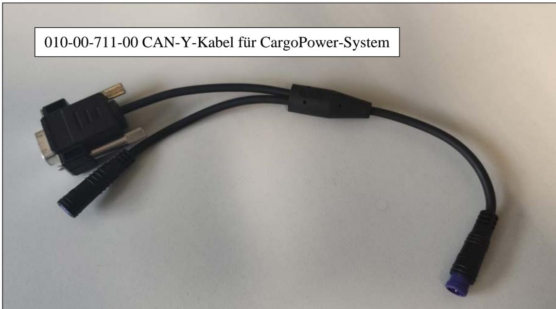
Am CAN-Y-Kabel befindet sich ein RS 232-Anschluss, an welchem ein CAN-Interface für USB installiert wird:
