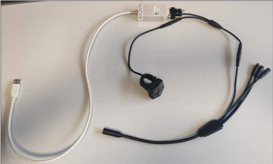
Der USB-Stecker am CAN-Interface für USB wird an den Port am PC angesteckt.
