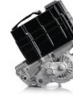
Der Marktführer für **Elektromotorräder** KTM hat seine Enduro „Freeride“ mit dem HEINZMANN PMS 120 motorisiert. Der flüssigkeitsgekühlte Elektromotor leistet 16 kW (22 PS) Spitze und hat aus dem Stand ein Drehmoment von 42 Nm. Mit anderen Worten: das Motorrad legt mit lediglich 111 Kilo Gewicht einen absoluten Schnellstart hin. Purer Fahrspaß ohne Krach und Abgase.
