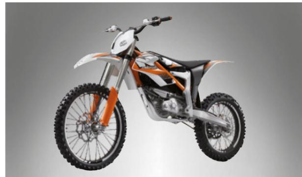
Auf Grund seiner Bauform, einer hohen Leistungsdichte und einem geringen Trägheitsmoment, das sehr gute Beschleunigungseigenschaften bietet, ist der Scheibenläufermotor prädestiniert für den Einbau in ein Zweirad.
